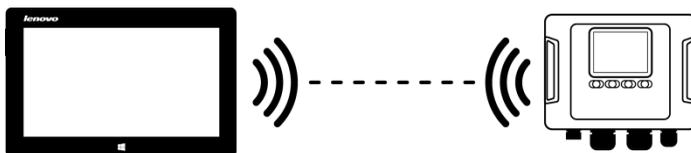
**Abb. 30. Direktverbindung Tablet/PC (Client) ↔ Analysator (AP).**
