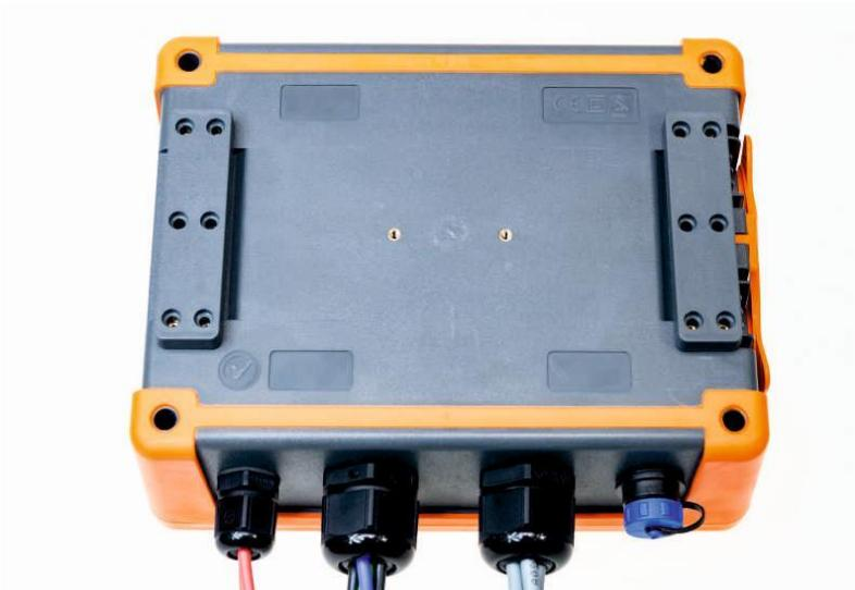
3. Schrauben Sie die Stecker mit 10 Stück M3x10-Schrauben an das Gehäuse. **Es dürfen nur Schrauben mit den in diesem Handbuch angegebenen Abmessungen verwendet werden.**
