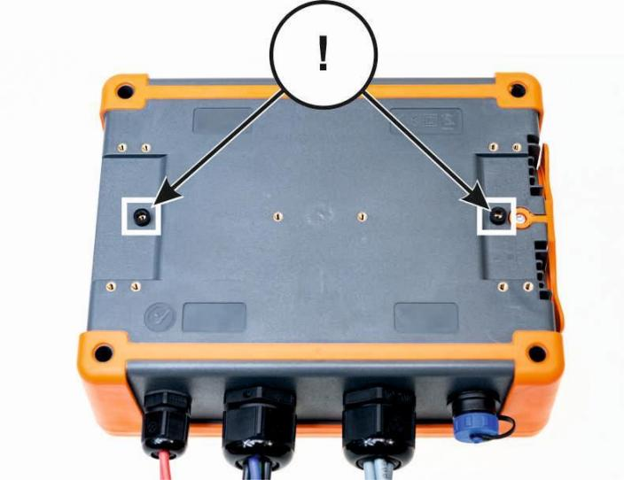
2. Bringen Sie die Schellenverbinder an der Unterseite des unteren Gehäuses an den auf dem Foto markierten Stellen an.
