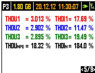
Abb. 9. Display 5 mit Verzerrungsfaktoren der Oberwellen THD.
