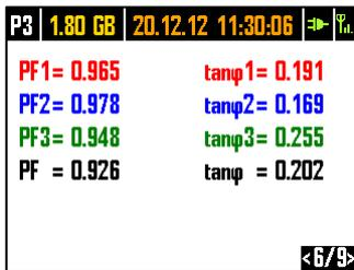
Abb. 10. Display 6 mit Leistungsfaktoren und  $tg\varphi$ .
