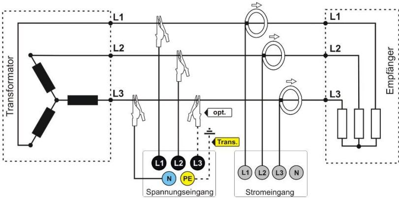
Abb. 19. Anschlussschaltbild – 3-Phasen-Stern-System ohne neutraler Leitung.
