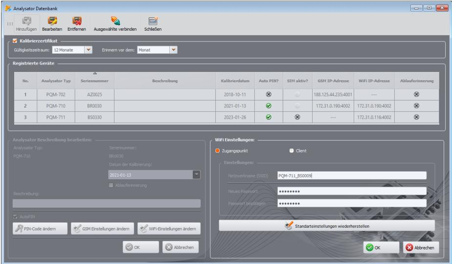
Abb. 33. Bildschirm zur Konfiguration des Wi-Fi-Zugangspunkts.
