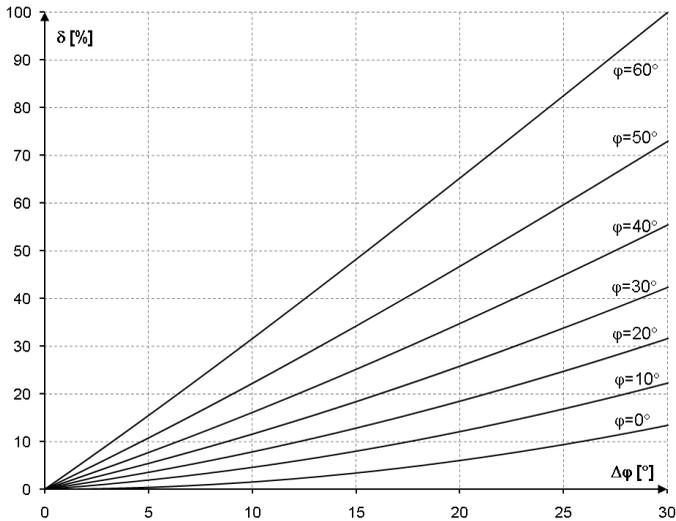
Abb. 43. Die zusätzliche Unsicherheit des Phasenfehlers in Abhängigkeit vom Winkel der Phasenverschiebung.
